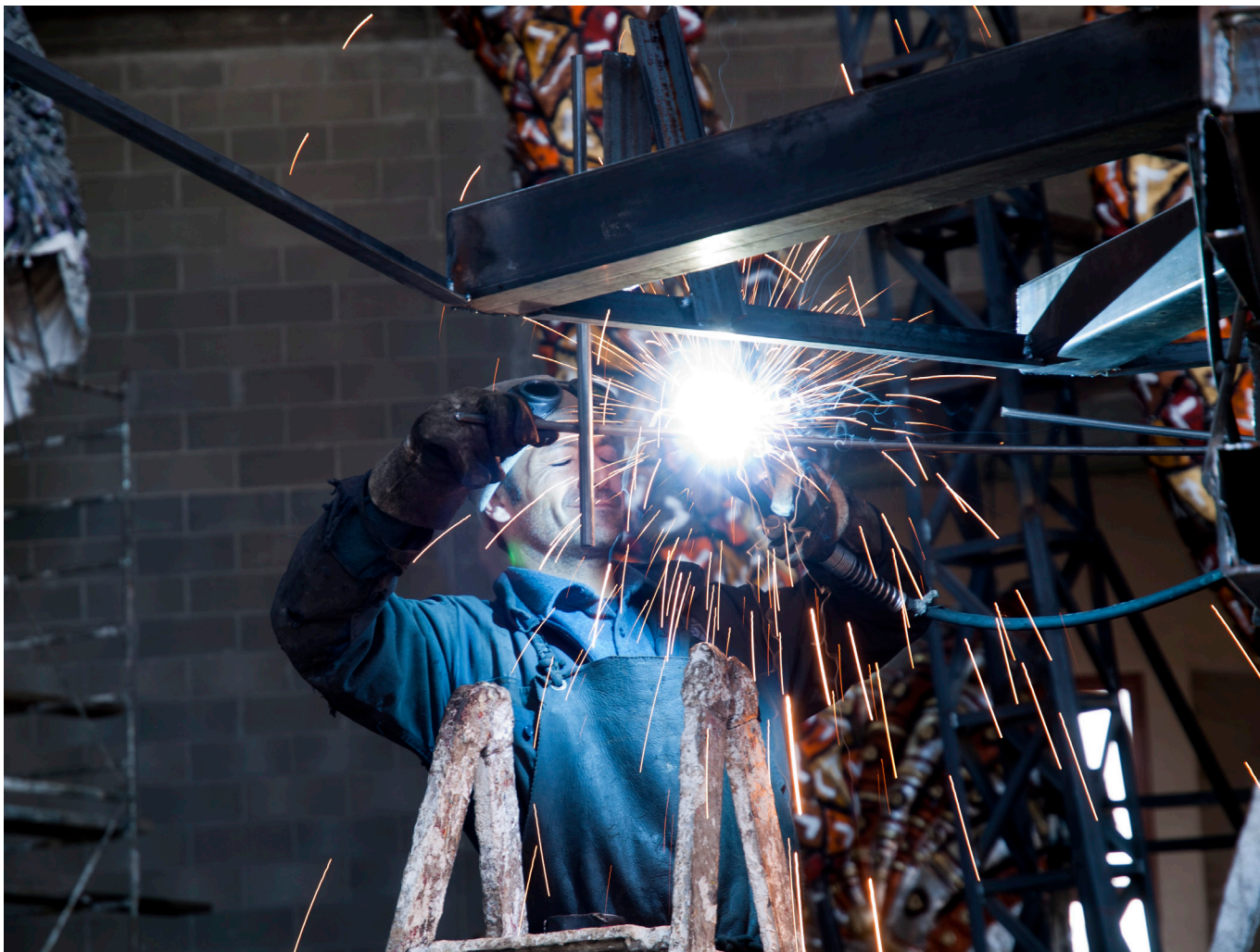
Saldatura della struttura esterna del carro
